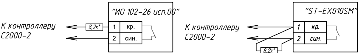
Схема подключения магнитоконтактных извещателей и кнопок выхода
